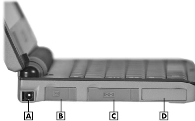
**A** – AC Power port **B** – VGA port **C** – Serial port **D** – Not Used
